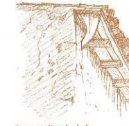
Support d'angle de la couverture dit "jambe de cheûn"
